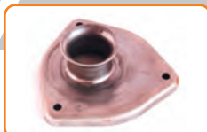
Корпус наружный верхней опоры стойки передней подвески с опорой подшипника в сборе
