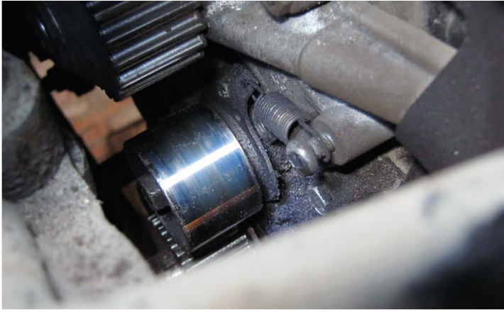
▲ Простая, на первый взгляд, пружинка выполняет важнейшую роль – она задает усилие, с которым ролик давит на ремень и задает его натяжение
