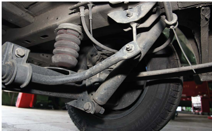
▲ В задней подвеске грузовика есть стабилизатор поперечной устойчивости. Следите за состоянием его «косточки»
