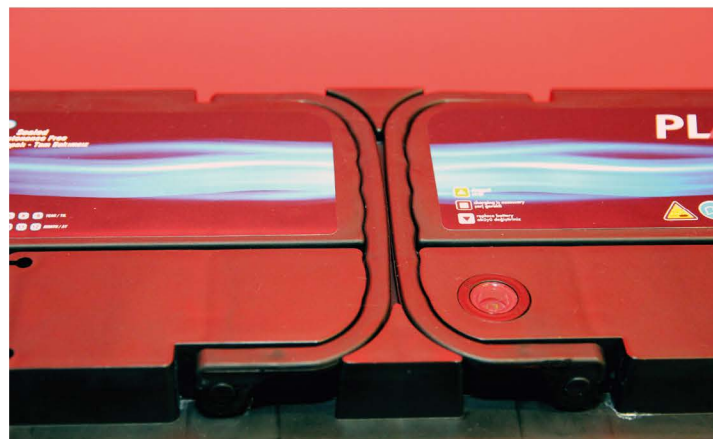
▲ На ряде аккумуляторных батарей имеются «глазки» индикатора состояния. Важно, чтобы цвет в окошке был всегда зеленым, – АКБ заряжена
