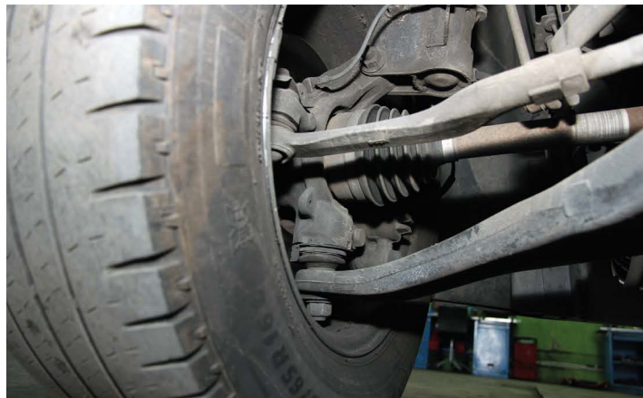
▲ При таком расположении шаровой опоры шарнир не «саморазберется» даже при сильном его износе
