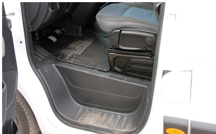
▲ Вход в грузовик на редкость удобен благодаря широкому дверному проему и низко расположенной ступеньке
