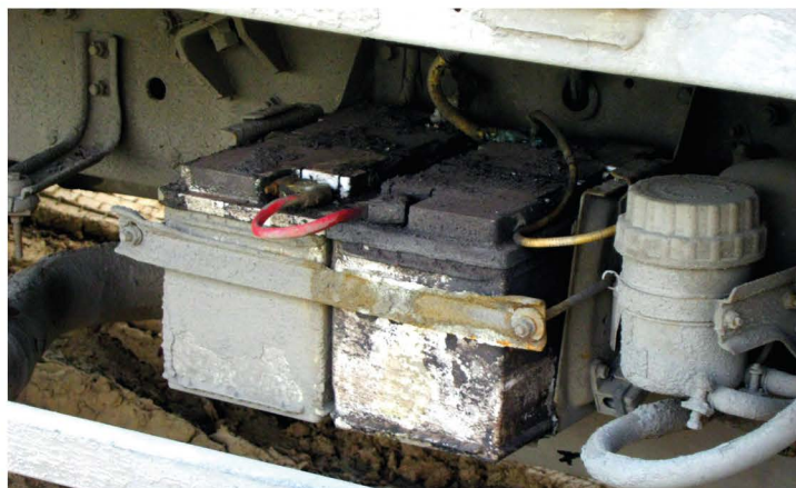
▲ На грузовиках аккумуляторные батареи часто открыты всем ветрам, а без верхней крышки еще и интенсивно зарастают грязью – вот и цепь для разряда
