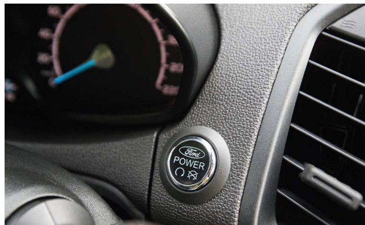
▲ В топовых версиях Ford EcoSport оснащается кнопкой, которой запускается и останавливается двигатель
