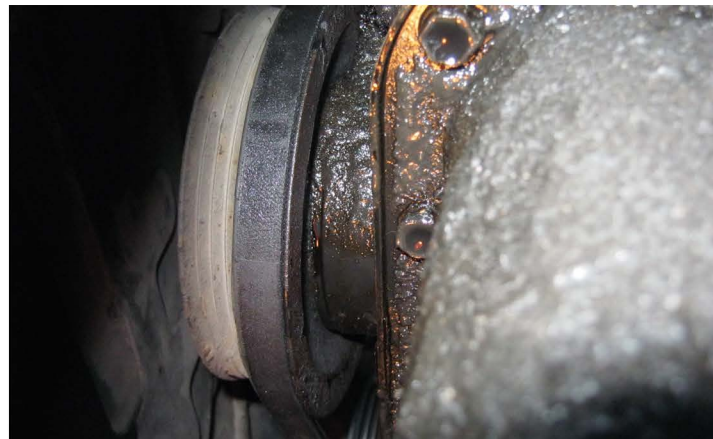
▲ Приводной ремень генератора может также замазаться. При этом он начинает проскальзывать, что отражается на энергоснабжении авто
