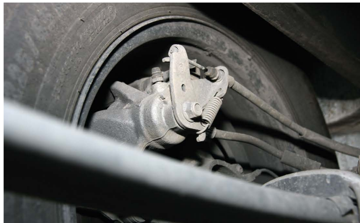
▲ Дисковые тормозные механизмы с суппортами, оснащенными приводом стояночного тормоза. Следите за чехлами троса!
