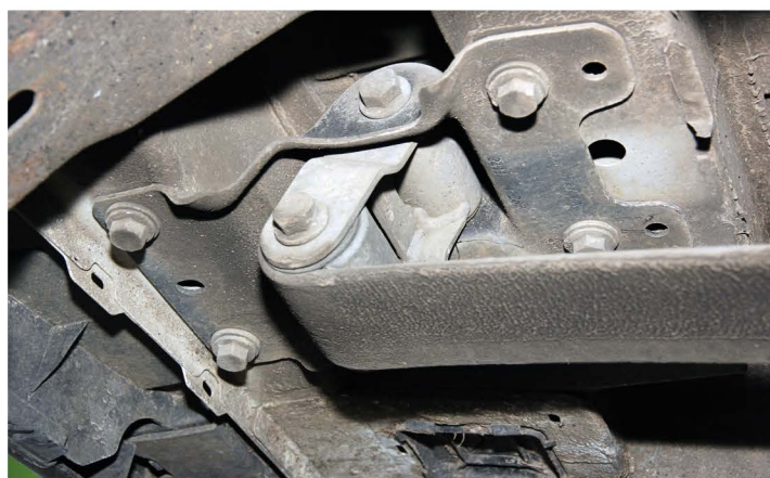
▲ Рессора крепится к кузову через «серьгу». В «уши» запрессованы сайлентблоки. Обслуживать их не требуется
