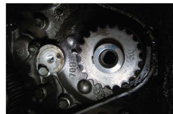
▲ Метки на шкиве вала и шестерни коленвала «разбежались» на один зуб
