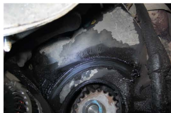
▲ Ответные метки нанесены на нижней крышке
