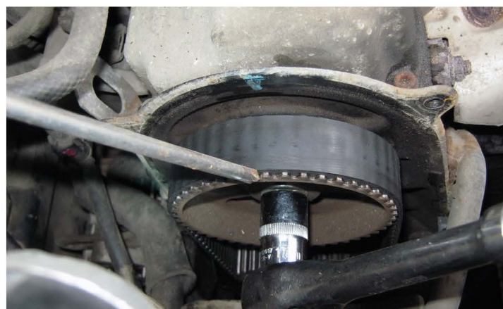
▲ Осмотреть состояние ремня привода ГРМ можно, вращая шестерню за болт ее крепления. Попутно совмещаем метки на корпусе и шестерне
