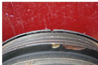
▲ На шкиве коленчатого вала имеется метка для фиксации его положения
