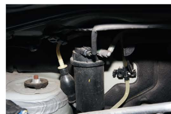
▲ Резиновая груша нужна для удаления пузырей из топливной системы
