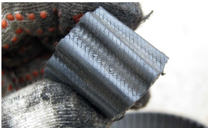
▲ В целом, состояние данного ремня привода ГРМ можно оценить как хорошее. Запас по пробегу не менее 10 000 км
