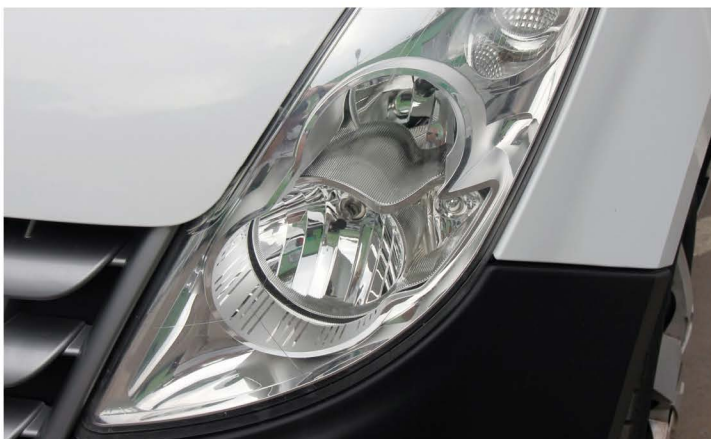
▲ Многосекционные блок-фары закрыты прочным поликарбонатным стеклом. Если оно потерлось — отполируйте
