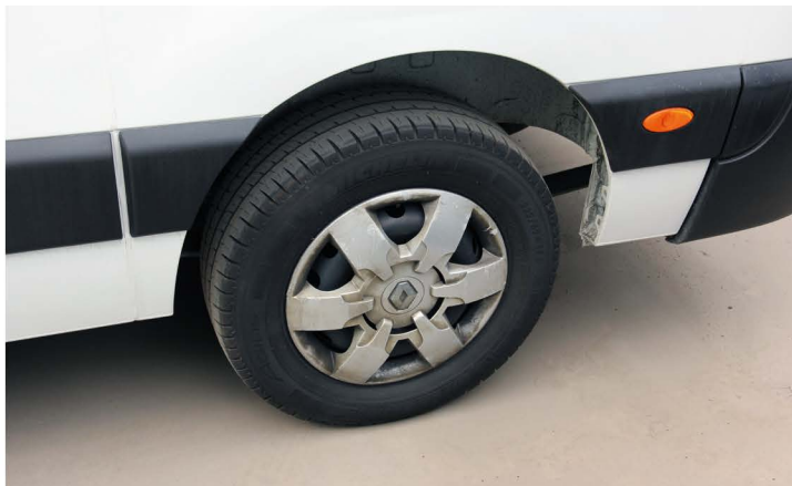
▲ Однорядная ошиновка задней оси говорит об ограничении грузоподъемности машины. Размерность 225/65 R16 C
