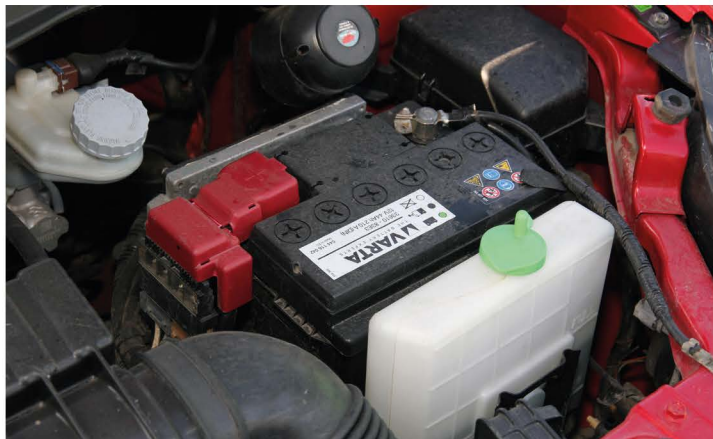
▲ Так расположен аккумулятор в подкапотном пространстве Suzuki Swift. На замену ищите аккумулятор с аналогичными геометрическими размерами
