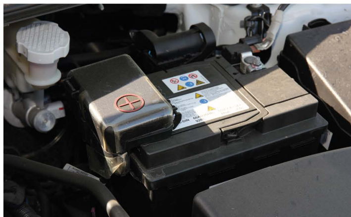
▲ Аккумулятор под капотом автомобиля Kia Ceed. Обратите внимание на то, как закрыт положительный контакт. Замкнуть батарею невозможно
