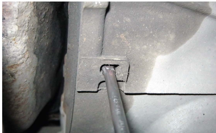
▲ Чтобы коленчатый вал при откручивании болта шкива не проворачивался, его фиксируют отверткой, вставленной в паз колокола маховика
