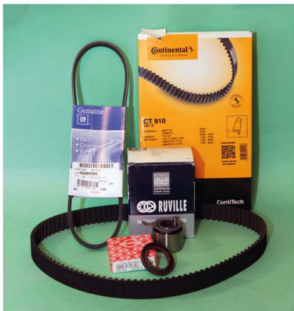
▲ Набор запасных частей, необходимых при ремонте привода ГРМ. Как правило, параллельно меняют и приводные ремни генератора, кондиционера, ГУР
