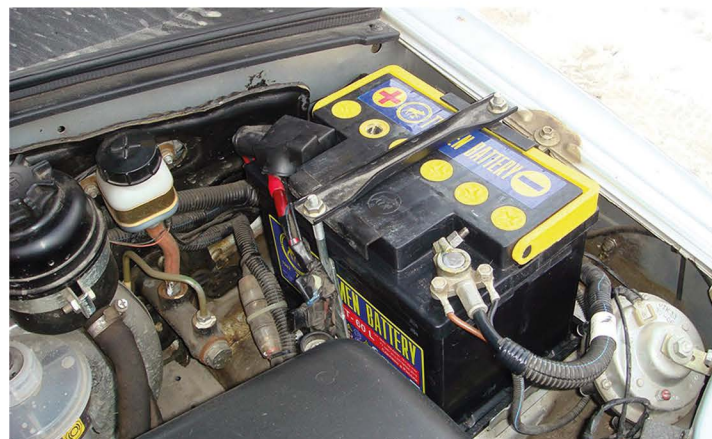
▲ Крепление аккумулятора Шевроле Нива длинными шпильками с верхней металлической планкой не очень удобное, особенно при демонтаже АКБ на морозе
