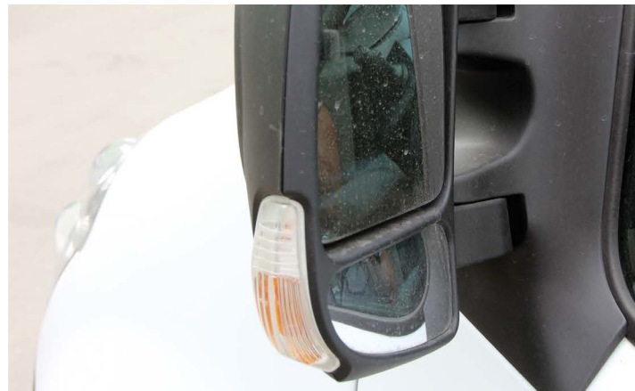
▲ Двухсекционные зеркала с повторителем поворота – это не только хороший обзор мертвых зон, но и безопасность
