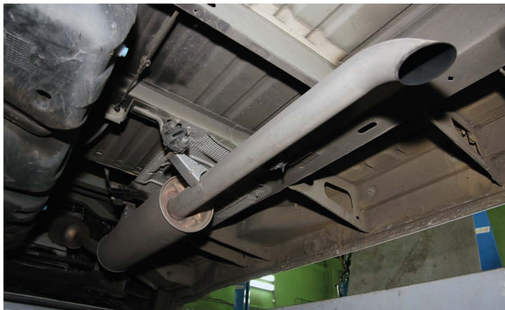
▲ За три года интенсивной эксплуатации на глушителе нет и намека на коррозию. Качество стали на высоком уровне
