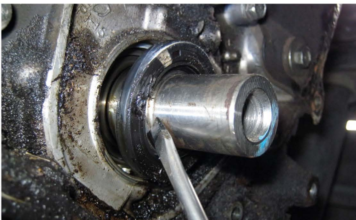
▲ Изношенный сальник большинство руководств по ремонту автомобилей рекомендует демонтировать, поддев отверткой. Не поцарапайте вал!
