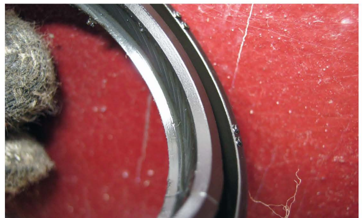
▲ У изношенного сальника кромки «тупые», а сам материал, из которого изготовлена манжета, твердый. Герметичности соединения не ждите
