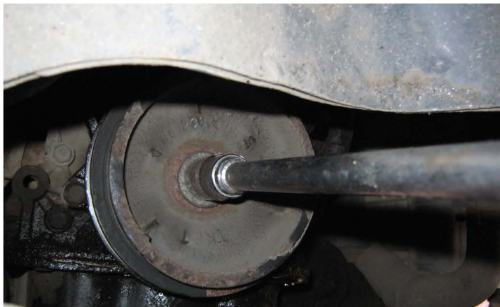
▲ Чтобы снять нижнюю крышку привода, демонтируем шкив. Его болт на сервисах часто намертво закручивают пневмогайковертом, а нужно динамометрическим ключом
