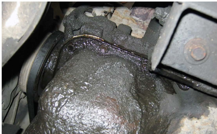
▲ Текущий (изношенный) сальник в буквальном смысле слова заливает маслом все вокруг, но самое опасное – замазанный ремень ГРМ
