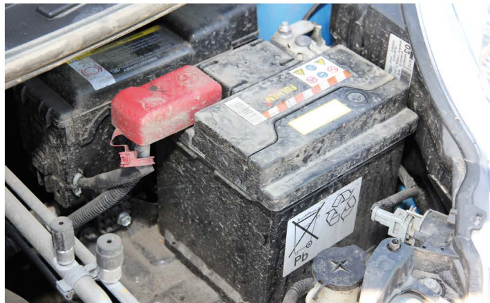
▲ Если крышка батареи грязная, то возможен ее ускоренный саморазряд. Не ленитесь протирать аккумулятор – грязь, особенно мокрая, есть отличный проводник тока
