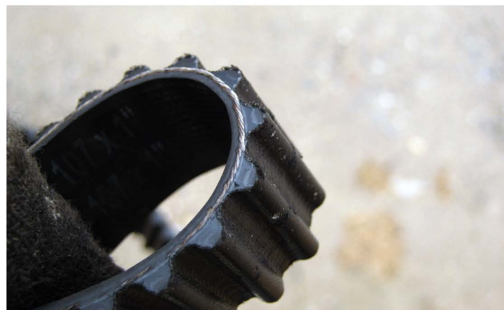
▲ Если ремень «гуляет» по шкивам, то на его торцевой части могут образовываться вот такие «заеды». При этом ремень отработал 50 000 км
