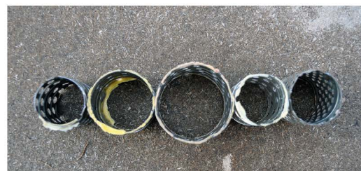
▲ Высота и диаметр внутренней обечайки, а также количество, форма и размер отверстий у них также различны
