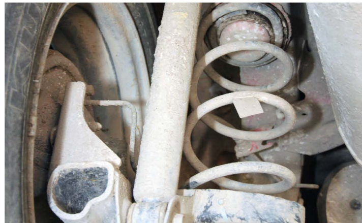
▲ Задняя подвеска – сама простота. Заменить пружину или «махнуть» амортизатор можно за считанные минуты
