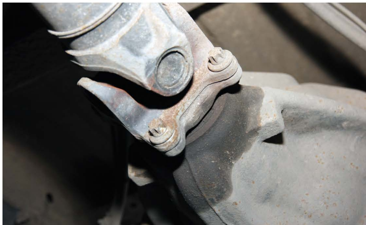
▲ Если редуктор начал потеть маслом, то следите за его уровнем и готовьтесь к замене сальника. Затягивать с ремонтом не стоит – редуктор очень дорогой
