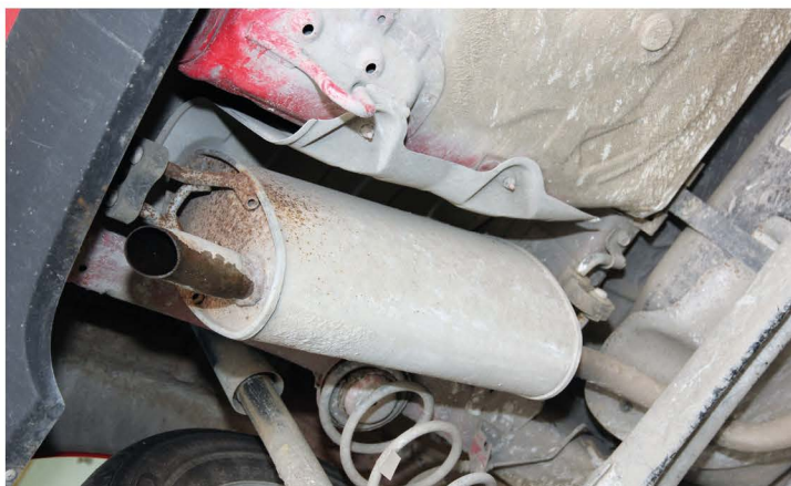
▲ Раньше всех в системе выпуска сгорает конечный глушитель. Цена вопроса с работой – как минимум 3200 рублей
