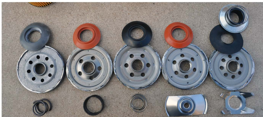
▲ У всех фильтров, кроме изделия от FORTECH, конструкция запорного клапана одинакова
