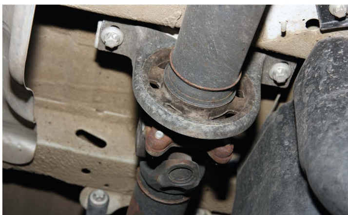
▲ Карданный вал длиннобазной версии грузовика имеет промежуточную опору. Перед покупкой машины обязательно проверьте состояние опоры
