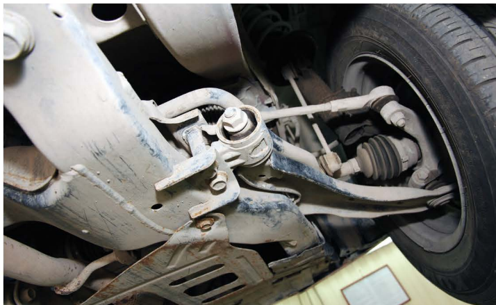
▲ Нижние рычаги передней подвески довольно крепкие, однако при неаккуратной езде шаровые могут застучать при пробеге 80 000 км
