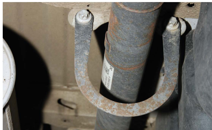
▲ Карданный вал длинный. Для страховки инженеры предусмотрели в конструкции привода крепкие стальные ловушки
