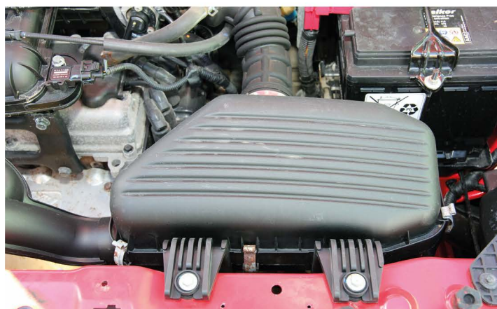
▲ Корпус воздушного фильтра как на ладони. Крышка крепится на защелках. На замену фильтроэлемента уходят считанные минуты
