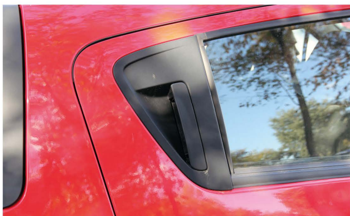
▲ Ручка задней двери расположена в верхнем углу. Оригинально, но непривычно
