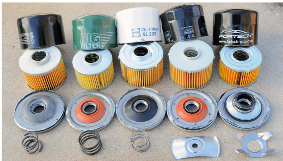
▲ После вскрытия. Снизу вверх – прижимные пружины, основания с запорным клапаном, фильтрующие элементы, внешние корпуса
