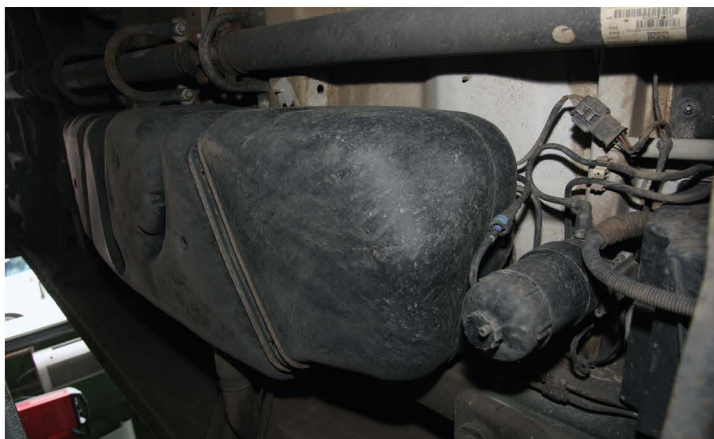
▲ На машине с большим пробегом перед началом эксплуатации лучше промыть топливный бак, благо, демонтировать его совсем не сложно
