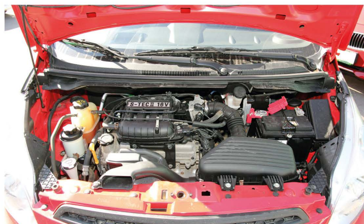
▲ Под капотом очень тесно. Доступ к ряду узлов и деталей сверху просто невозможен. Поэтому потребуется подъемник
