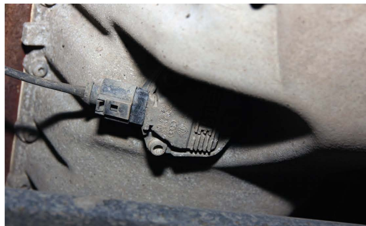
▲ Легкосъемные электрические разъемы имеют влагозащищенное исполнение. Кабели качественные – на морозе оплетка не трескается
