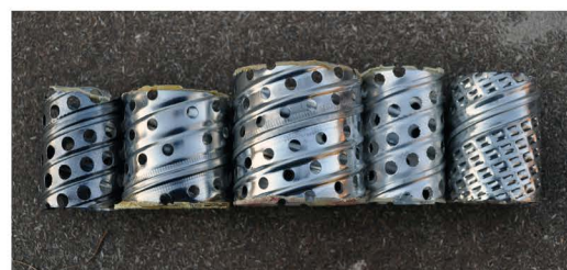
▲ Высота и диаметр внутренней обечайки, а также количество, форма и размер отверстий у них также различны
