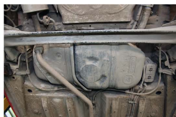
▲ Топливный бак – пластиковый. Такой не подвержен коррозии
