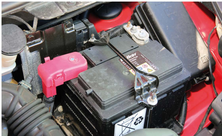
▲ Аккумулятор емкостью не блещет. Если АКБ более пяти лет, то в зиму с таким лучше не идти. Новый стоит примерно 4000 рублей
