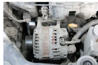
▲ Генератор находится высоко. Приводной ремень – поликлиновый
