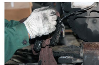
▲ При ремонте замкового механизма заменяем трубопровод подвода смазки
