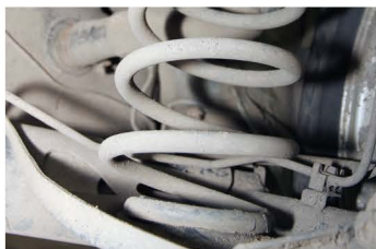
▲ Пружины бочкообразной формы. Обеспечивает комфорт при загрузке а/м
