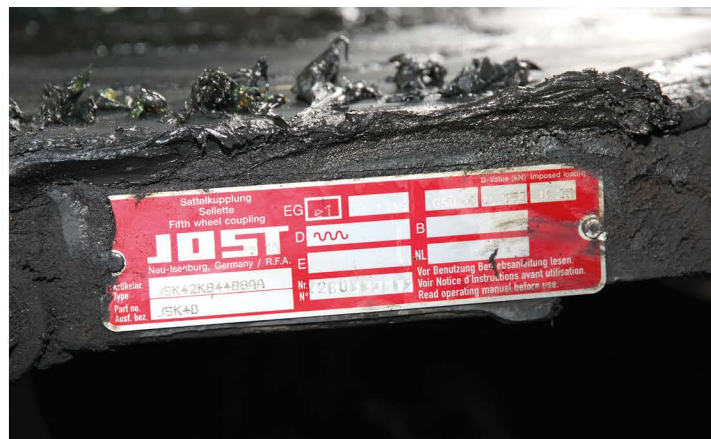
▲ Чтобы не ошибиться с выбором нужного ремонтного комплекта, выписываем все данные ССУ с таблички, закрепленной на торце седла
