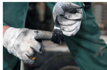
▲ Выработка замкового механизма может достигать нескольких миллиметров
