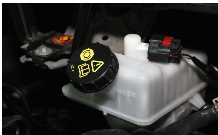
▲ Перед покупкой а/м посмотрите на цвет жидкости. Если она темная, то тормозная система не обслуживалась, возможна коррозия суппортов и цилиндров
