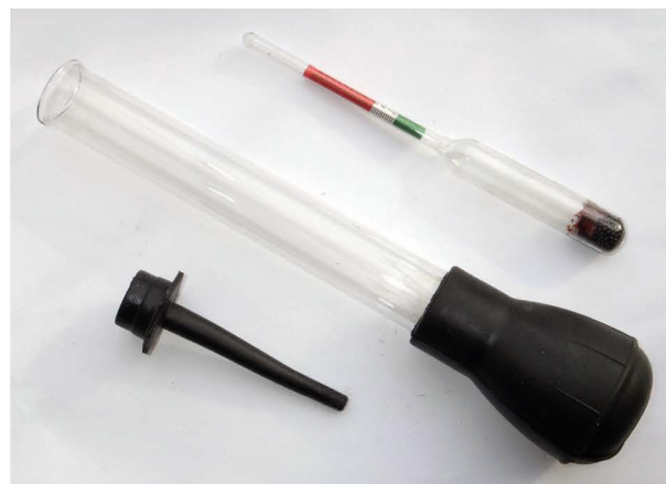
▲ Ареометр – прибор для измерения плотности электролита. Современным автомобилистам он уже незнаком
