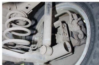
▲ Если на корпусе амортизатора есть потеки масла, меняйте его незамедлительно
