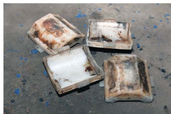
▲ Изношенные «корыта» отправляем на свалку. Методов восстановления нет
