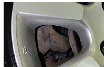
▲ Диски должны обеспечивать отличный обдув тормозного механизма
