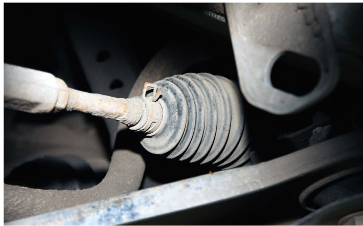
▲ Перед покупкой машины обязательно проверьте целостность чехлов рулевой рейки. Также «пулемет» не должен потеть маслом
