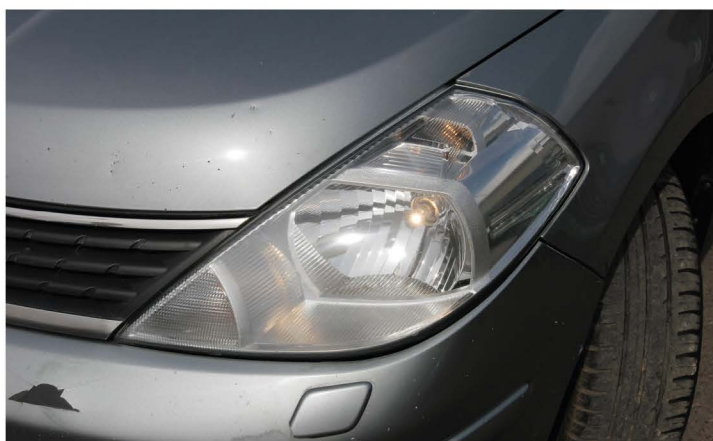
▲ Потертые абразивом покровные стекла фар можно отполировать (600 рублей), а вот ремонт омывателя обойдется куда в более солидную сумму
