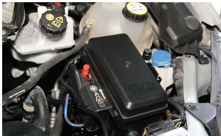
▲ Электрика в герметичных блоках – очень актуально для российских условий эксплуатации
