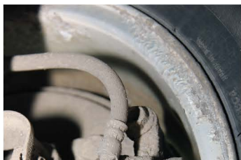
▲ Суппорта не должны подклинивать, а тормозные шланги – не иметь трещин
