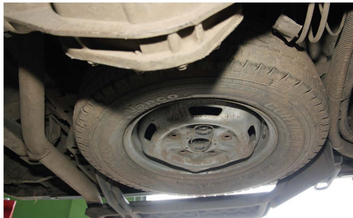
▲ Запасное колесо закреплено под днищем и не «съедает» полезного объема фургона. Вот только доставать «запаску» не удобно, особенно когда на дорогах снег и слякоть
