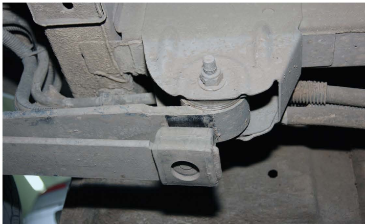
▲ В «ушах» рессор необслуживаемые сайлент-блоки. Вторая рессора включается в работу с ростом загрузки автомобиля
