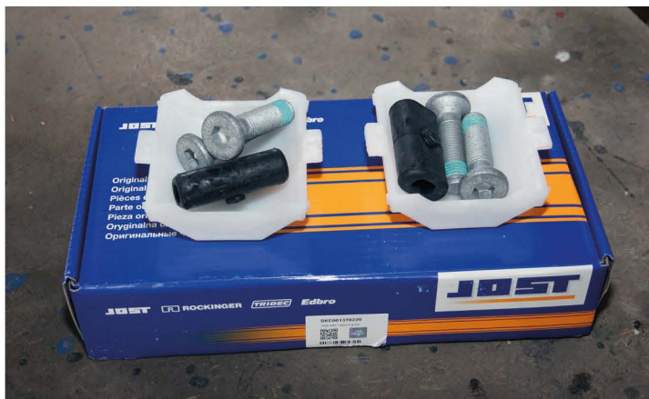
▲ Ремонтный комплект от производителя ССУ гарантирует 100%-ную совместимость деталей с седлом и самый высокий ресурс узла. Цена также самая высокая
