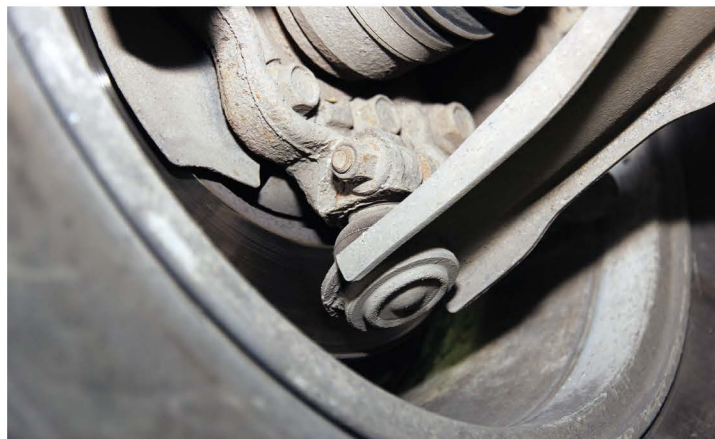
▲ Наши дороги и небрежная езда могут легко прикончить шаровые опоры к пробегу в 70 – 80 тыс. км
