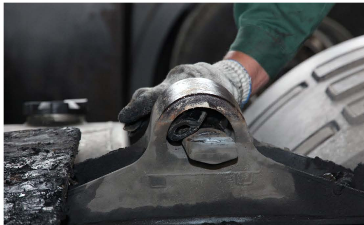
▲ Проблем с опорными кронштейнами практически не бывает. Их поверхность также не изнашивается, так как контактирует с плитой через пластиковые вставки
