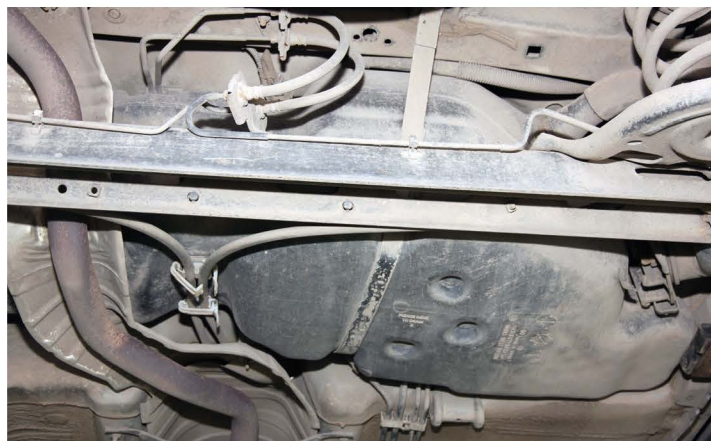
▲ Бензобак можно было бы и закрыть листом железа. Его пробой на грунтовке, ведущей к даче, обернется вам покупкой нового. А стоит это более 20 000 рублей
