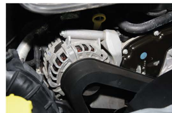
▲ Конструкторы предусмотрительно закрыли приводной ремень генератора щитком
