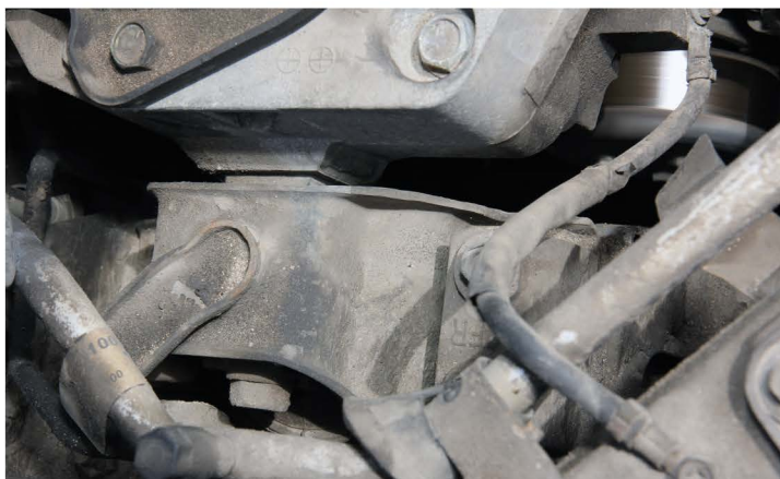
▲ У машин с пробегом под 100 000 км проверьте состояние опор силового агрегата. При малейшем подозрении – торгуйтесь и снижайте стоимость авто минимум на 8 000 рублей
