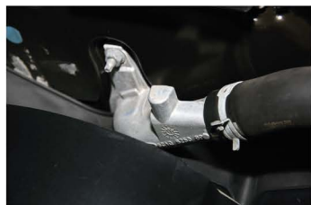
▲ Патрубки сжимают пружинные хомуты. С ними упрощается монтаж / демонтаж
