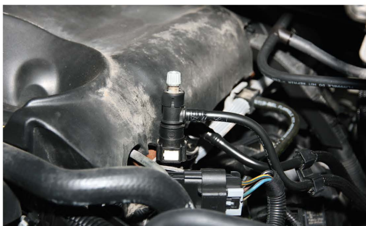
▲ Трубопроводы оканчиваются легкосъемными разъемами. Для их демонтажа достаточно нажать на фиксаторы и потянуть «клипсу» вверх
